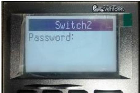
**Nota:** Si luego de realizar el procedimiento se muestra el siguiente mensaje será necesario aplicar nuevamente el "apriete" de 7 KgF en los switch de seguridad de ambos equipos.
