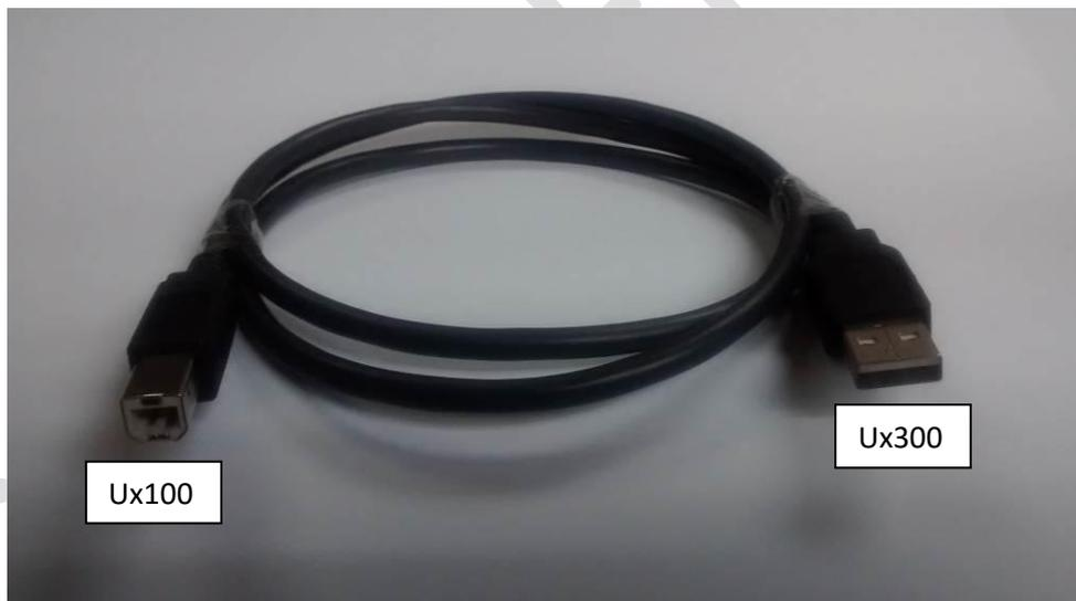
El extremo con el conector UBS tipo A se conecta en el Ux300 mientras que el conector USB tipo B va al Ux100, como muestra la figura
