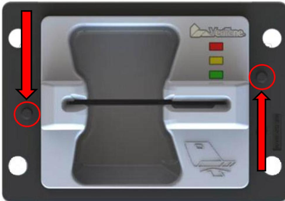
En las imágenes anteriores se identifican los switch de seguridad. **Estos se activan a causa de la falta de apriete sobre ellos.**
